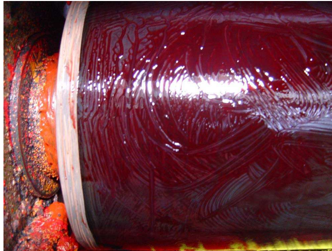
PREPARAT RECYL COBRA W TRAKCIE PIERWSZEJ REAKCJI Z MOCNO ZASCHNIĘTYMI POZOSTAŁOŚCIAMI FARB NA WAŁKU
